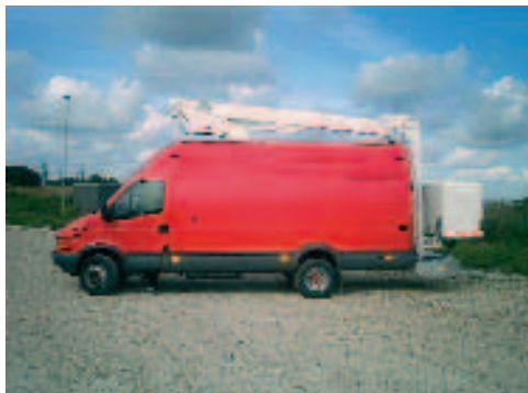
Die WDT-Reihe ergänzt den Kommunalgerätebereich des Unternehmens. Besonderheit dieser Arbeitsbühnen: ein teleskopierbarer Hubarm.
