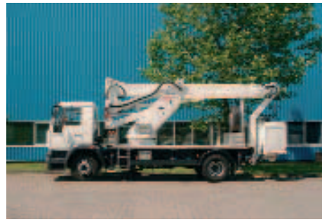
Schon eher ein Nischengerät: die WGT 250. Die Lkw-Arbeitsbühne ist auf große schwere Lkw-Fahrgestelle aufgebaut. Dank des Parallelogramms kann der Bediener eine bestimmte Höhe erzielen, so dass über Hindernisse hinweg gearbeitet werden kann.
